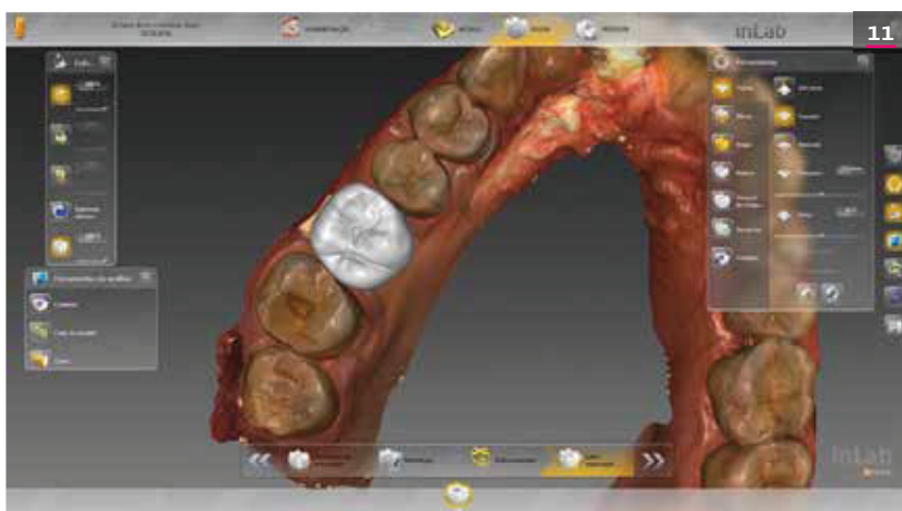
Figura 11 - Desenho da prótese (CAD).
